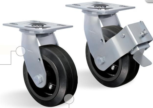
**HORQUILLA** Horquilla reforzada, fabricada en chapa estampada y cabezal con doble banda de bolas, acabado en zinc. Eje de la rueda atornillado.
