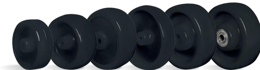
**NPP - Polipropileno. Dureza: 65 Shore D. (-20°C a +70°C).** Produzidas em injeção única com polipropileno copolímero reciclável. Indicadas para cargas leves, rodam com muita facilidade requerendo pouco esforço para movimentação, não deformam sob carga estática e possuem ótima relação custo/benefício. Apresentam boa resistência química e a impactos moderados. A velocidade de trabalho indicada é até 4km/h.
