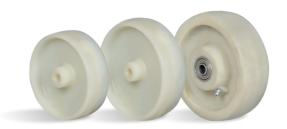
**NFV - Nylon Reforçado com Fibra de Vidro. Dureza: 80 Shore D. (-40°C) a +180°C).** Produzidas com Poliamida 6.6 (Nylon) reforçado com fibra de vidro. Indicadas para aplicações em altas e baixas temperaturas. São leves, possuem ótima resistência mecânica, rodam com muita facilidade exigindo menor esforço para manobras e movimentação. São resistentes a graxas, óleos, sais e alguns tipos de ácidos. A velocidade de trabalho indicada é até 4km/h.
