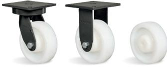
**RODA NTT - Nylon Técnico. Dureza: 75 Shore D. (-40°C a +110°C).** Produzida em injeção única com Poliamida 6 (Nylon) de alta qualidade. É leve, possui ótima resistência mecânica, roda com muita facilidade exigindo menor esforço para manobras e movimentação, não deforma sob carga estática. Ideal para aplicações em ambientes úmidos, é resistente a graxas, óleos, sais e alguns tipos de ácidos. Fabricada com material reciclável. A velocidade de trabalho indicada é até 4 km/h.
