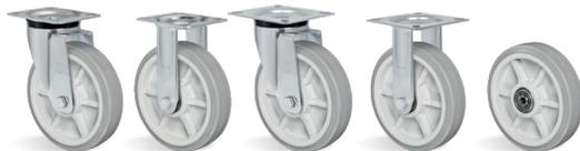
**RODA SP - Borracha Termoplástica Extra Macia. Dureza: 65 Shore A. (-10°C a +50°C).** Roda injetada com revestimento em borracha termoplástica extra macia e núcleo em polipropileno copolímero recicláveis. Suas vantagens são o baixíssimo nível de ruído no deslocamento e a redução de vibrações. Indicada para movimentações de cargas leves, proporciona excelente proteção ao piso, resistência regular a impactos e boa resistência a meios químicos. A velocidade de trabalho indicada é até 4km/h.
