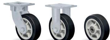
**RODA TP - Composto Termoplástico.** Dureza: 85 Shore A. (-10°C a +50°C). Produzida com revestimento em composto termoplástico e núcleo em polipropileno copolímero recicláveis. Proporciona rodagem macia e silenciosa, ótima proteção ao piso, excelente resistência química, boa resistência ao desgaste e impactos, resultando em ótima relação custo/benefício. A velocidade de trabalho indicada é até 4km/h.
